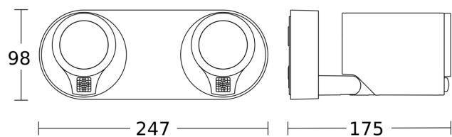
Possibile altezza di montaggio: 1,80 m - 2,50 m
